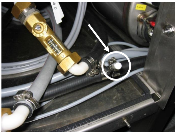
Obrázek: poslední mycí zóna s niplem pro oplachový prostředek
