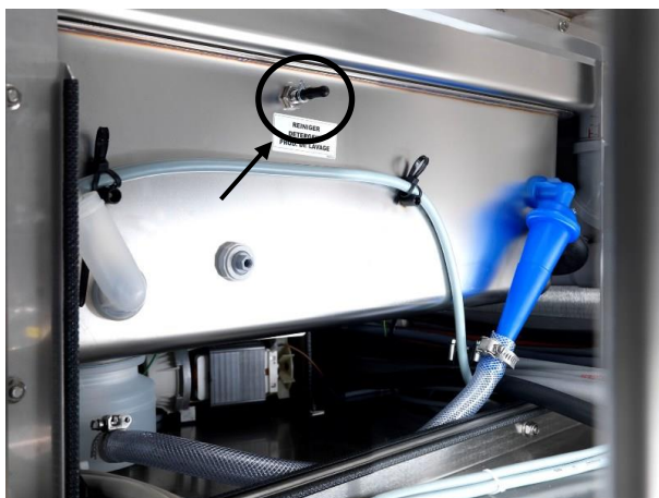
Obrázek: První hlavní mycí zóna s dávkovací vsuvkou pro mycí prostředek
