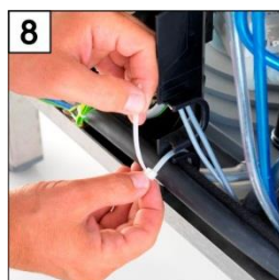
8 K přichycení vodičů upevněte síťový přívod kabelovou páskou na montážní desku.
